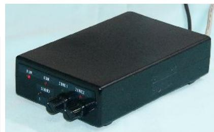
1 chの入力信号(重心動揺計のY信号など)のレベルがある範囲の値になったことを検出し、2系統の検出信号の出力並び、検出信号に同期したビープ音とLEDの点灯を行うものです。範囲は2帯域 (ZONE) 設定でき、L1~H1 or L2~H2 の間とします。Windows PCと組み合わせてご利用いただけるものです。
