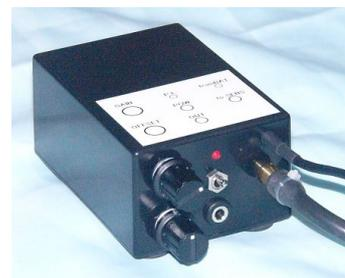
蛇腹タイプの呼吸センサと組み合わせて、呼吸を止めた時に記録が水平となるDC呼吸測定ができる呼吸アンプです。ゴム製蛇腹の内圧を測定し DC アンプで増幅することで微妙な呼吸の変化を捉えることができます。十分なゲインとオフセットの調整機能を持ち、小児から大人まで被験者の胸囲や腹囲の長さを気にせずご利用いただけます。
