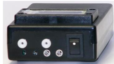
側面 電極接続部と電源スイッチ
