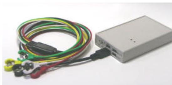
入力インピーダンス10G 及び、シールド電極コード により雑音除去性能を高め、
