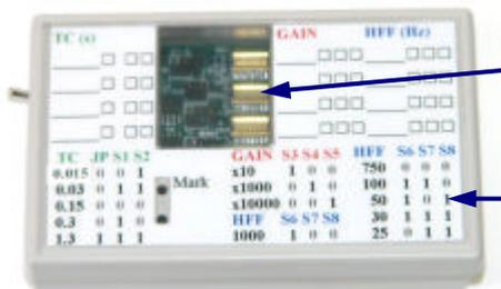
アンプの設定値が判るように透明のフィルム越しに見えるようにしたケースも用意しています。
